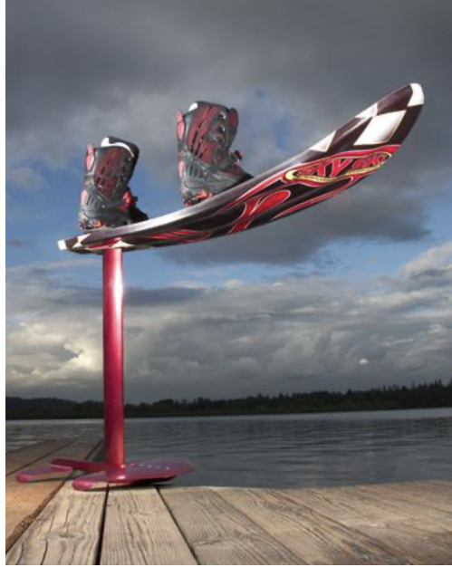
Figura 3.1.9: Diseño de hidroala similar a los utilizados en la actualidad en los deportes acuáticos. Fuente: Pohl M.J, Aungst B. J, (2009) "Hydrofoiling History" recuperado el 15.09.2020 de la página web http : //www.hydrofoil.org/ history.html .
