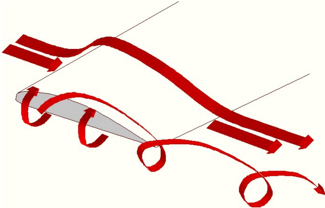
Figura 6.1.2: Vórtices en punta de ala.
