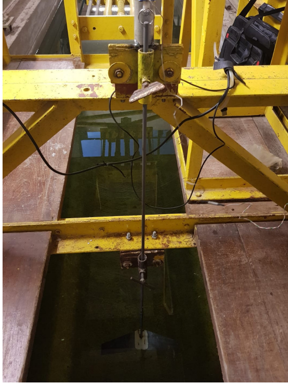
Figura 9.2.2: Montaje experimental del ala trasera, siendo similar a la delantera. Fuente: Elaboración propia.
