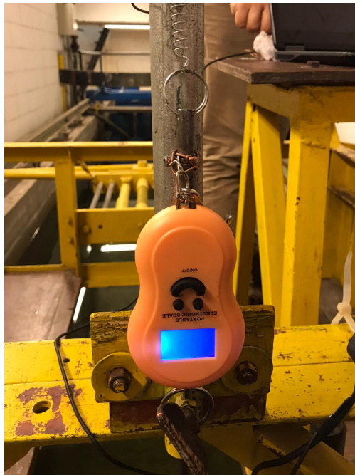
Figura 9.2.3: Montaje de la balanza utilizada para medir la fuerza de sustentación generada por las alas. Fuente: Elaboración propia.
