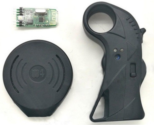
Figura 7.2.4: Controlador del propulsor. Fuente: recuperado de la página web del artículo en Aliexpress.
