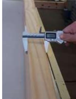
Figura 7. Medida de espesor con calibre digital.
