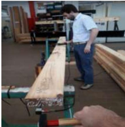
Figura 28. Ensayo utilizando Fakopp.
