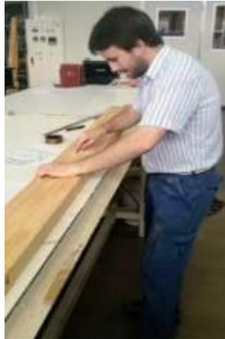
Figura 20. Medición de desviación de la fibra.
