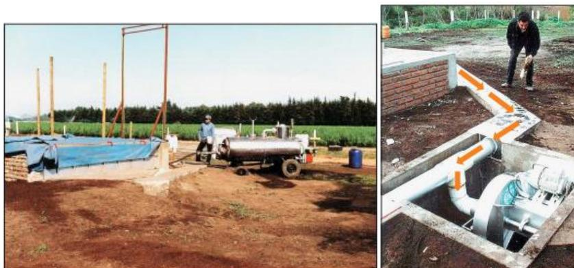
Sistema “bunker” con una caldera de construcción, que genera vapor y lo inyecta al interior del sustrato. Las “carpas” azules evitan pérdidas de vapor y temperatura. Y equipo extractor de vapor, que permite aumentar la eficiencia de la desinfección de sustratos, bajo el sistema “bunker”. Las flechas naranjas indican el sentido del flujo de vapor (Carrasco et al., 2006).
