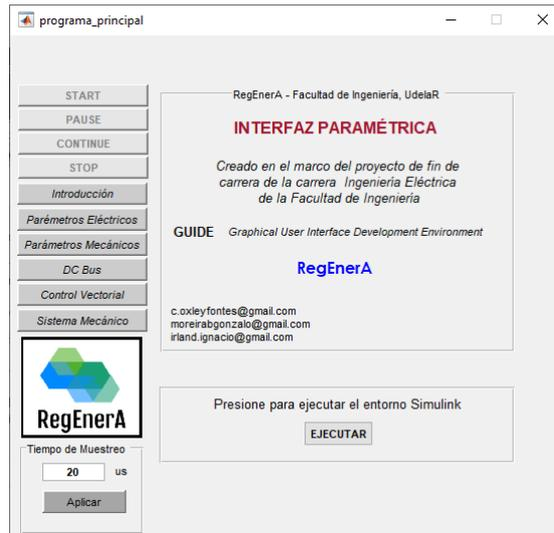
6. Presionar el botón **EJECUTAR** para abrir el entorno de *Simulink*. Se generarán dos curvas: “curva de carga” y “velocidad de referencia” que se deberán importar de manera simultánea en el generador de señal *Signal Builder*.
