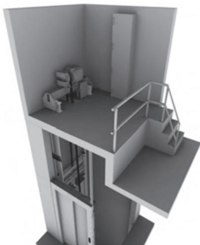
Figura 3.1: Ascensor con cuarto de máquinas. Fuente [21].
