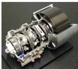
Figura 2.2: Dispositivo KERS de F1. Fuente [14].
