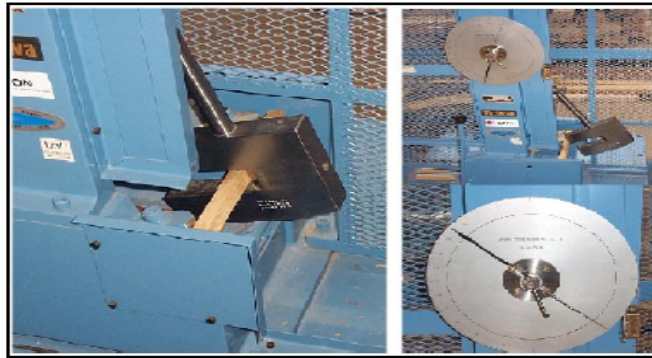
Figura N° 13: Disposición de la probeta libre de defectos para el ensayo de flexión dinámica.
