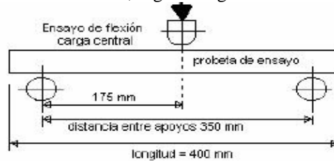
Figura N° 12: Esquema de aplicación de carga para probetas libres de defectos.
