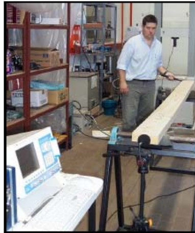
Figura N° 10: Disposición del FFT analyzer para la realización del ensayo.
