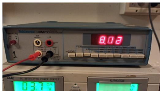
Figura 7.7: Corriente medida por un amperímetro en serie con el dispositivo en modo Barrido cuando no se están realizando transmisiones *Bluetooth*
