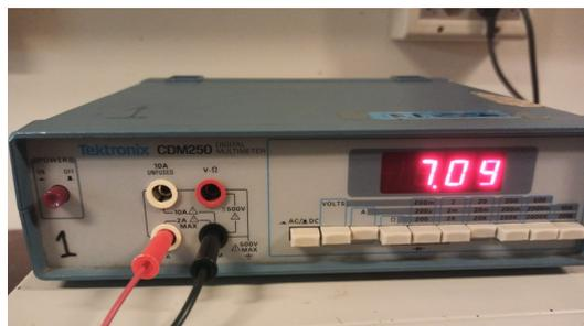
Figura 7.8: Corriente medida por un amperímetro en serie con el dispositivo en modo Gestos
