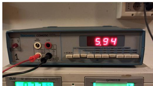
Figura 7.9: Corriente medida por un amperímetro en serie con el dispositivo en modo Cabeceo
