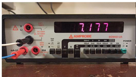
Figura 7.6: Corriente medida por un amperímetro en serie con el dispositivo en modo Barrido cuando se realizan transmisiones *Bluetooth*
