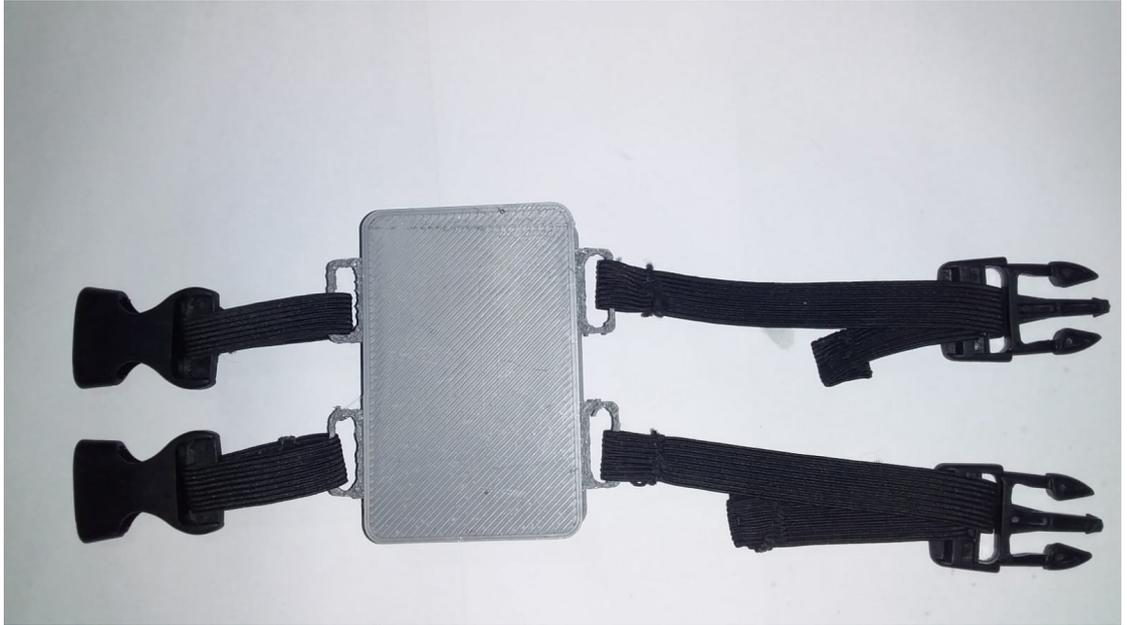
Figura 6.3: Método de sujeción del encapsulado Principal
