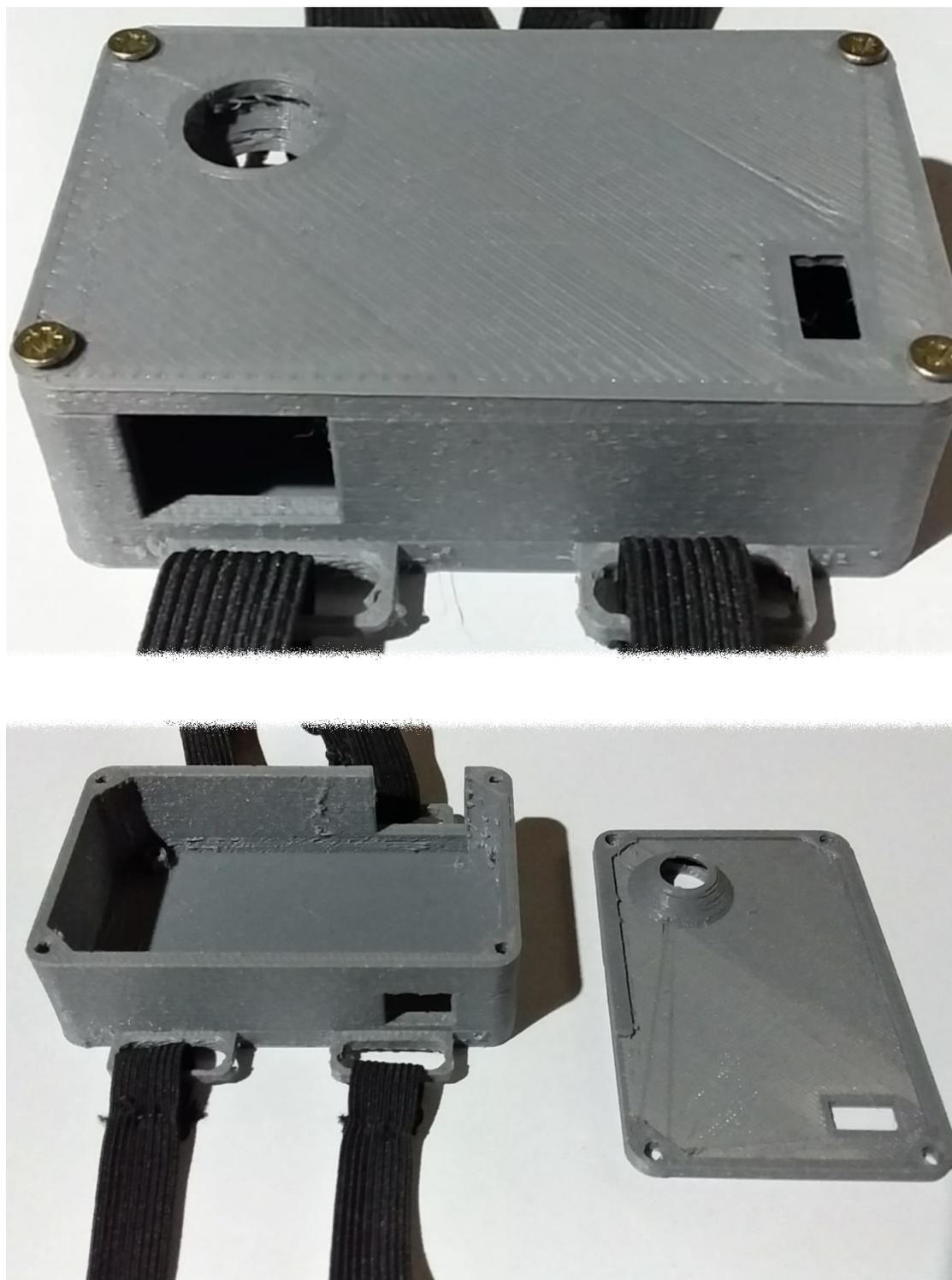
Figura 6.2: Encapsulado para la placa Principal
