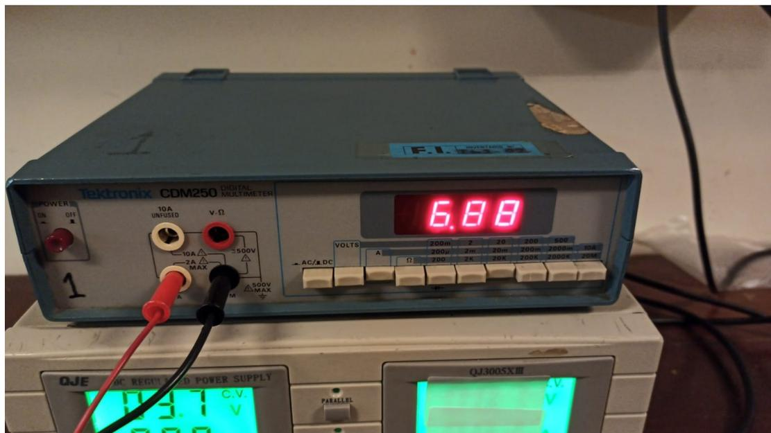
Figura 7.10: Corriente medida por un amperímetro en serie con el dispositivo en modo Botonera
