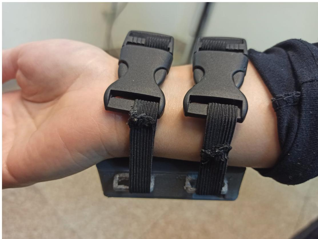
Figura 8.3: Método de sujeción del dispositivo final colocado en la muñeca
