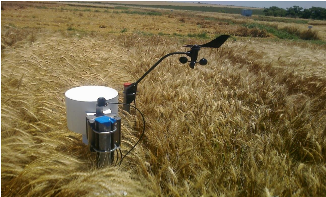
Estación meteorológica Decagon ® instalada en La Estanzuela
