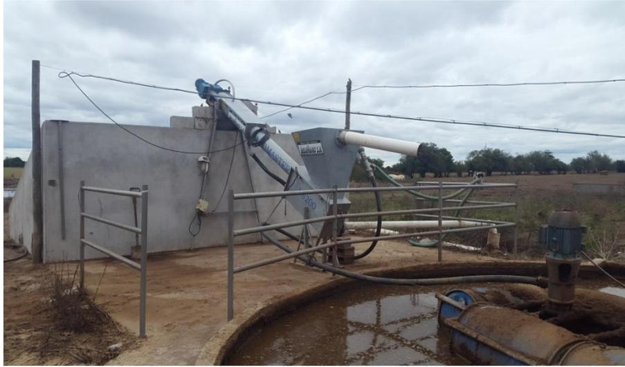
Figura No.4. Prensa extrusora del tambo 2
