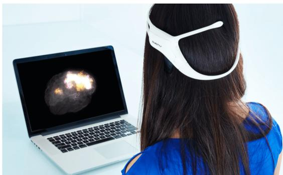
Gorra con sensores de solución salina EPOC Flex
