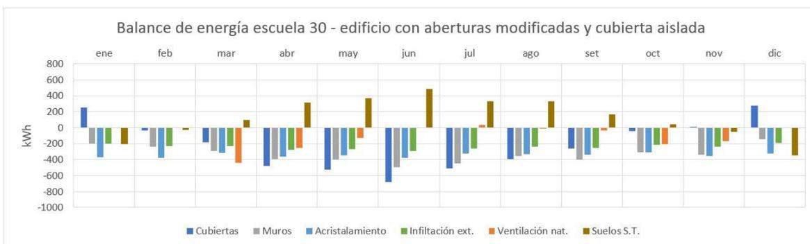
Gráfico 36 - Balance de energía edificio escuela 30 con aberturas modificadas y cubierta aislada.
