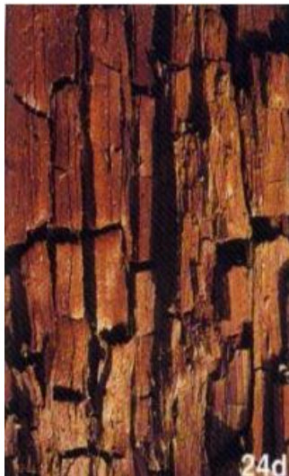
Figura 2. Podredumbre marrón sobre trozo de madera. 1
