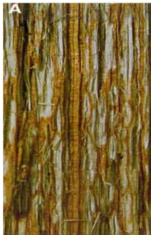
Figura 1. Podredumbre blanca sobre trozo de madera. 1
