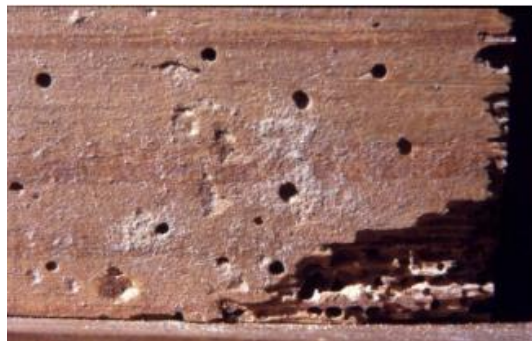
Figura 7. Trozo de madera atacado por Anobium punctatum . 3
