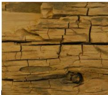
Figura 3. Podredumbre blanda sobre trozo de madera. 1
