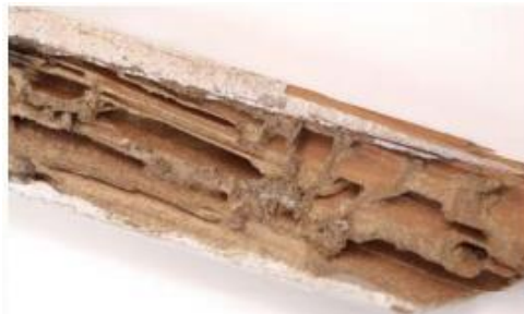
Figura 10. Trozo de madera atacado por Reticulitermes flavipes . 3
