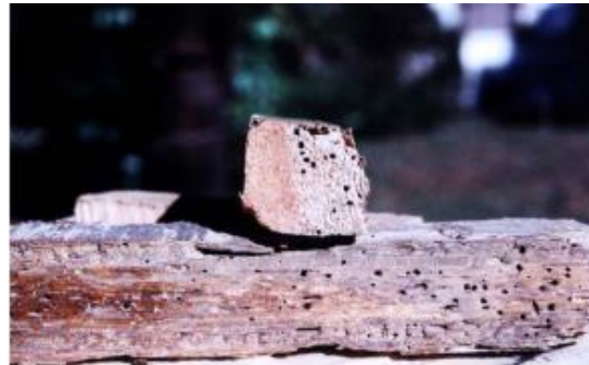
Figura 5. Trozo de madera ataco por Lyctus brunneus . 3
