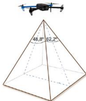
Figura No. 4. Campo de visión (FOV) de la cámara Raspberry PI.
