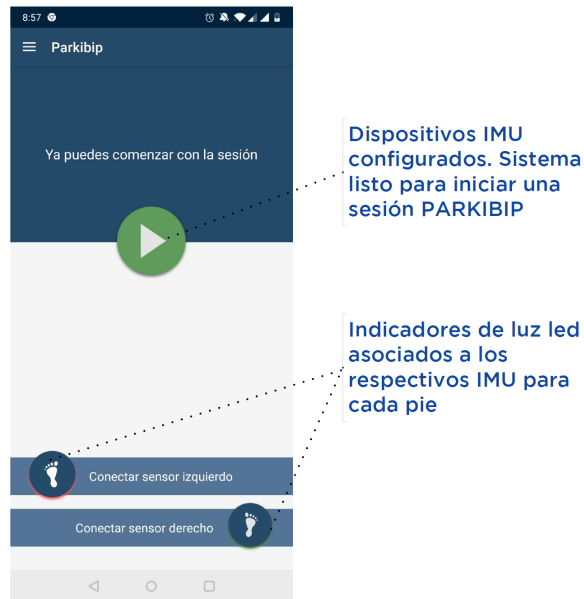
Figura 1.8: Configuración de los IMU exitosa. Ambos botones se encuentra en azul, las luces LED del IMU sincronizadas a los colores de los contornos de los botones, y el botón central es puesto en verde. PARKIBIP se encuentra listo para comenzar una sesión de rehabilitación.
