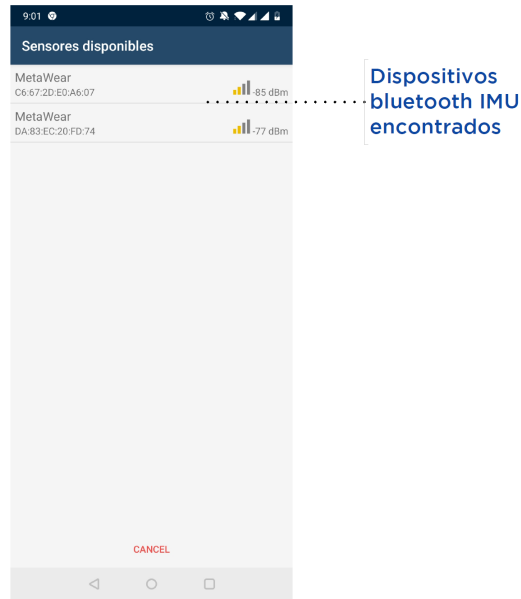
Figura 1.6: Escaneo de dispositivos IMU. Previa activación del modulo bluetooth, expone un listado de IMU en la cercania. Para cada uno muestra su identificador MAC, el tipo de IMU y la intensidad de la señal.
