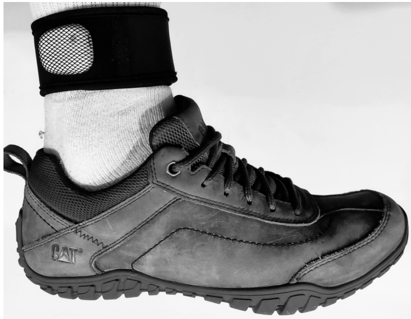
Figura 4.1: Banda elástica junto a la unidad de medición inercial (IMU).
