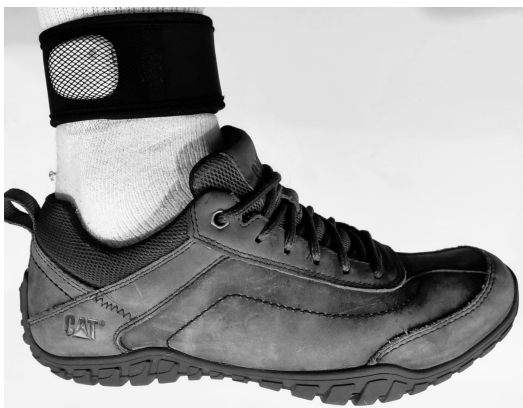
Figura 3: Banda elástica junto a la unidad de medición inercial (IMU)
