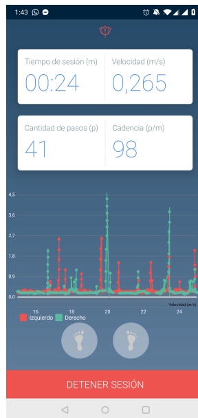
Figura 1.9: Pantalla de una Sesión Activa PARKIBIP. El sistema reacciona en tiempo real a la marcha del paciente en rehabilitación. Dispara estímulos externos -vibración y/o sonido- y computa los parámetros espacio-temporales.
