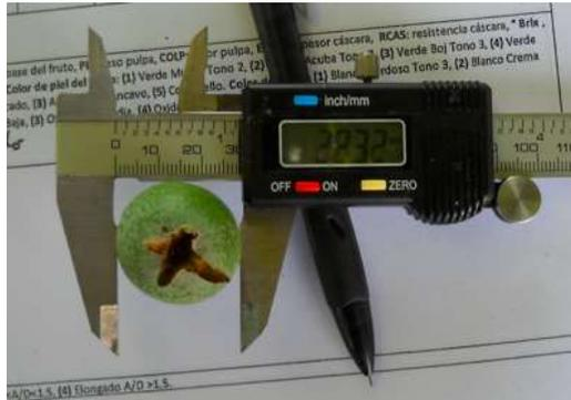
Figura 14. Medición de DF con calibre digital
