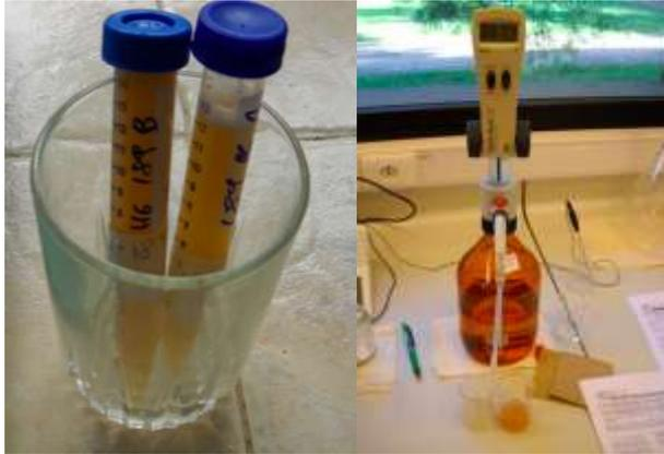
Figura 17. Medición de ATT en jugo de fruta diluido usando bureta digital
