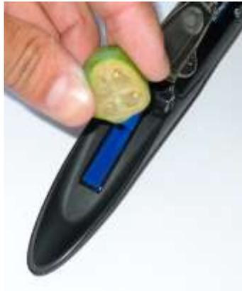
Figura 16. Medición de SST con refractómetro manual
