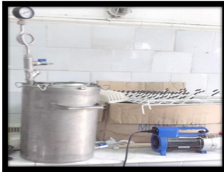
Figura 9. Cámara y bomba de vacío.
