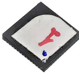
Figura D.1: Fotografía del ASIC desarrollado para el proyecto I3 por el grupo de microelectrónica del IIE, previo a ser soldado sobre el dispositivo vestible.
