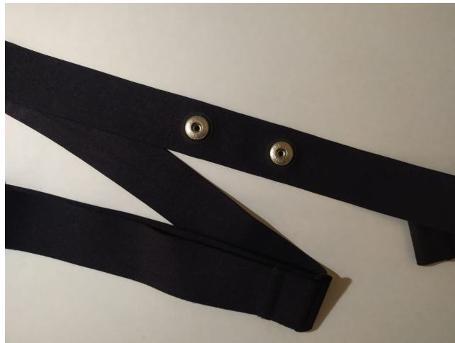
Figura 3.21: Cinta deportiva utilizada para anclar el dispositivo vestible al pecho del usuario. La cinta posee dos superficies conductoras alargadas en contacto con la piel del usuario, conectadas cada cual con un botón conductor. Estos botones aseguran no solo el anclaje mecánico de la PCB al usuario, sino también el contacto eléctrico con los electrodos de adquisición de ECG.
