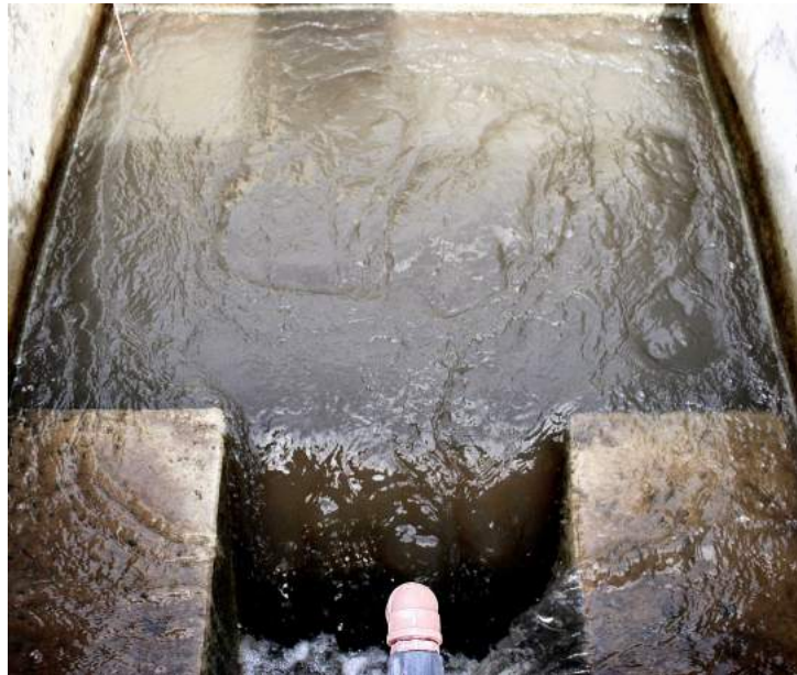
Figura 2.27: Resalto hidráulico en vertedero rectangular
