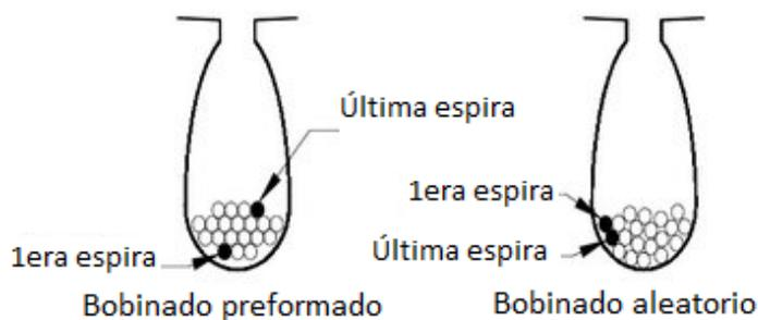
Figura 1.2: Bobinado preformado (izquierda) y aleatorio (derecha) [1]
