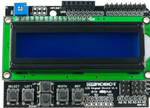
Figura 7.1: Imagen del display usado como interfaz con el usuario.
