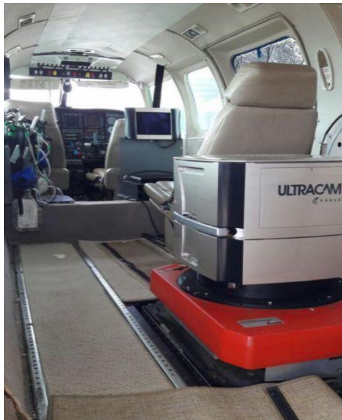
Imagen 3 Cámara Vexcel Ultracam Eagle Mk2 Fuente: gtbi en línea
