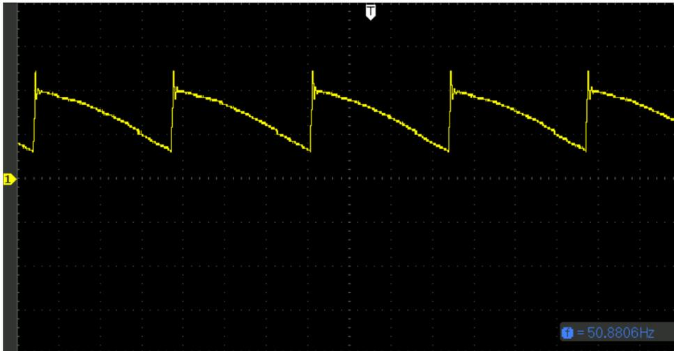
(a) Forma de onda para una tensión de 300 V, escala de tensión de 200 V/div, escala temporal de 1 ms/div.
