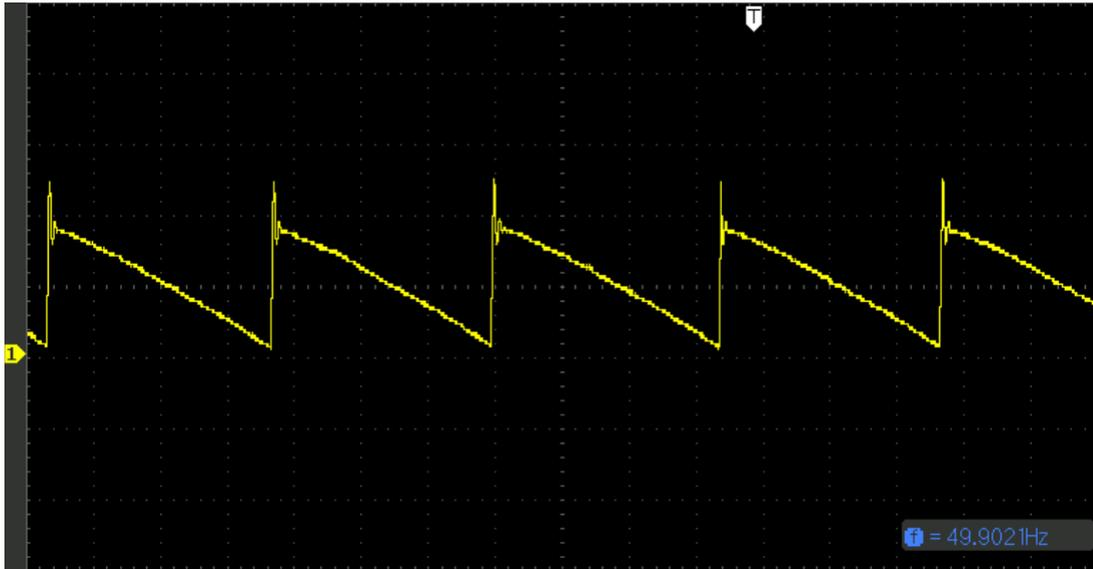
Figura 10.13: Voltaje de salida del puente de tiristores con *snubber* de apagado, escala de tensión de 200 V/div, escala temporal de 1 ms/div.
