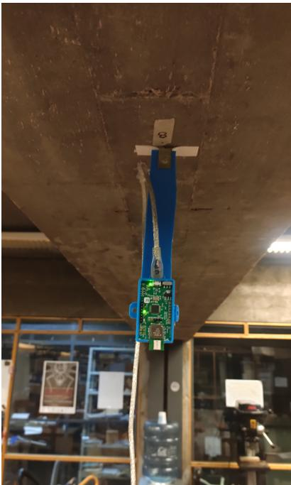
(c) Para la experimentación en el laboratorio, se dejó fijo el *tag*. En esta imagen se puede ver dónde se colocó: se encuentra alejado unos centímetros de la viga del techo para que esta no genere ruido a la hora de correr los experimentos.
