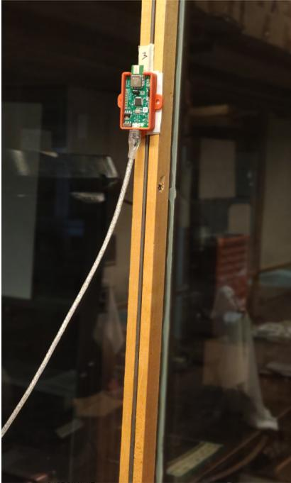
(a) Dispositivo en el marco de una ventana. La mayor parte de los puntos están en una disposición parecida, con línea de visión entre este dispositivo y el *tag*.
