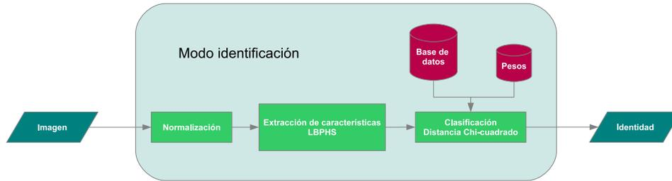
Figura 1.4: Implementación final del sistema en modo identificación
