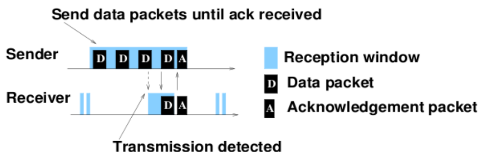
Figura 4: Escucha de bajo consumo con ContikiMAC
