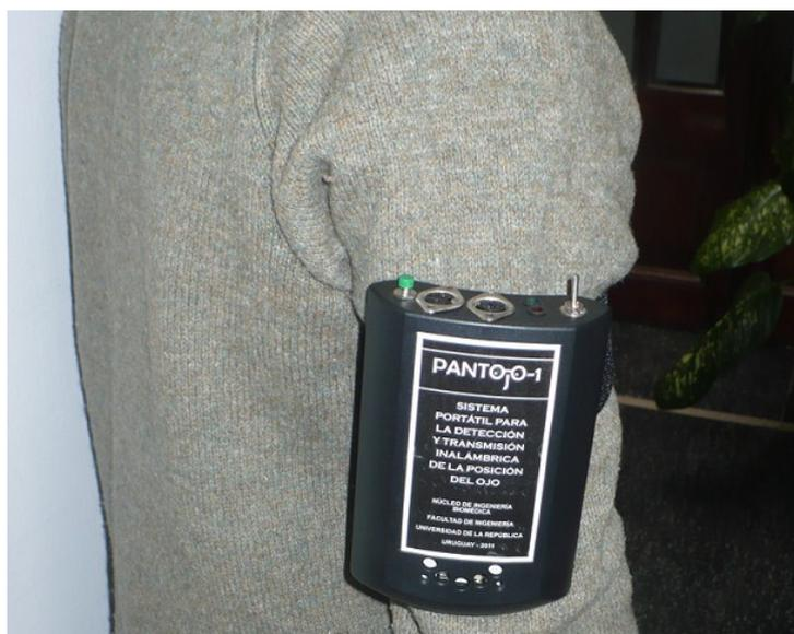
*Figura 8.18: Módulo principal de PANTOJO-1 fijado a un brazo*
