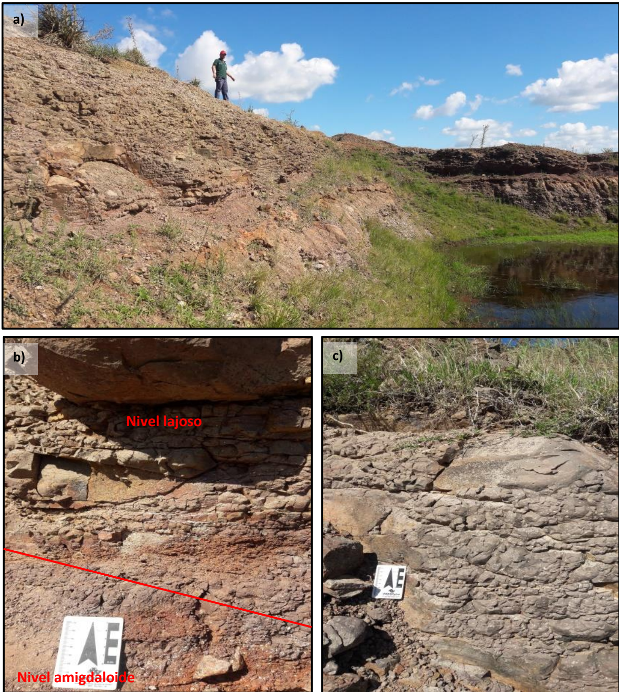
Figura 25. a) Vista panorámica cantera de basaltos de la Formación Arapey; b) Vista detalle separación basalto amigdaloides (inferior), basalto lajoso (superior); c) Vista en detalle basalto lajoso
