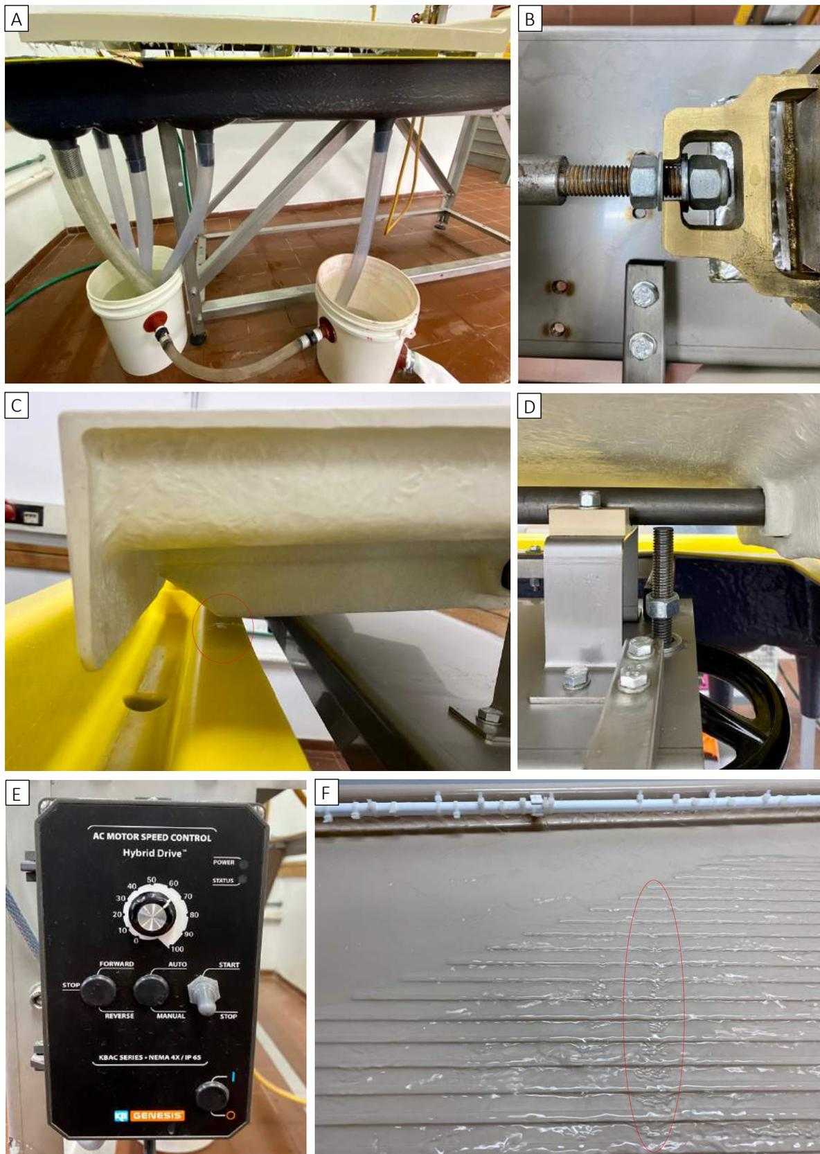
Figura 4.52: A) Disposición de los tubos de descarga de agua de la mesa. B) Tuerca de ajuste de inclinación transversal. C) Inclinación transversal inicial sugerida. D) Volante de ajuste de inclinación longitudinal. E) Selector de velocidad de carrera. F) Torrente de agua que debe ser evitado.
