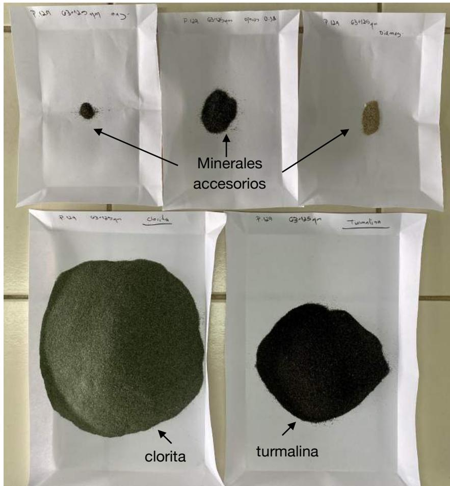
Figura 4.10: Minerales constituyentes de la turmalinita Cerro la Tuna. Las fracciones en la parte superior de la foto están formadas por los minerales accesorios, mientras la parte inferior se observan los minerales esenciales. Estos minerales se encuentran agrupados según sus susceptibilidades magnéticas.
