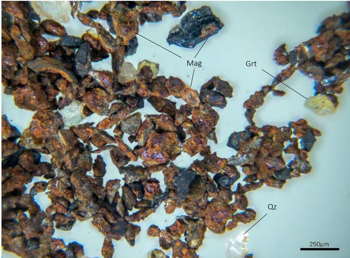
Figura 4.23: Minerales separados con imán de mano del granito P13. La fracción está compuesta mayormente por fragmentos de magnetita (Mag). Se observan otros minerales como el cuarzo (Qz) y granate (Grt).
