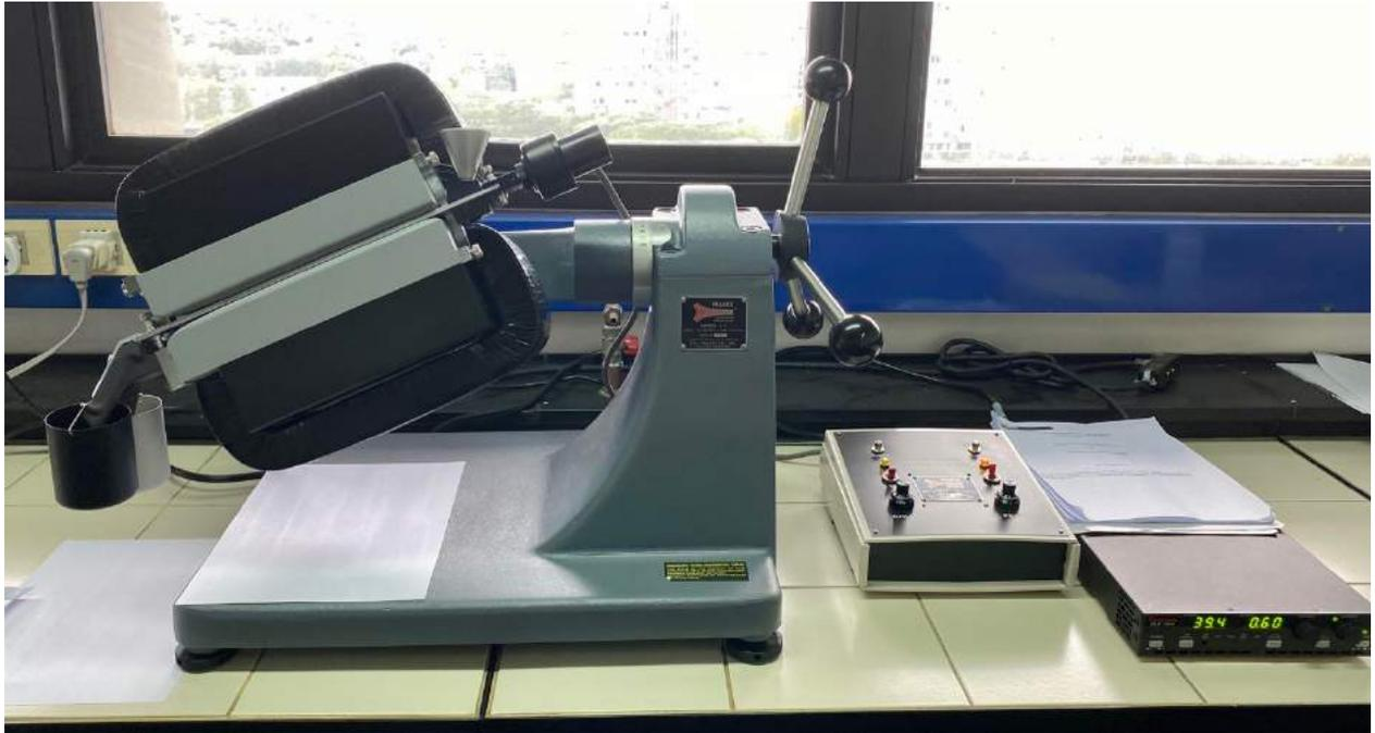
Figura 2.10: Separador Isodinámico Frantz modelo L-1.
