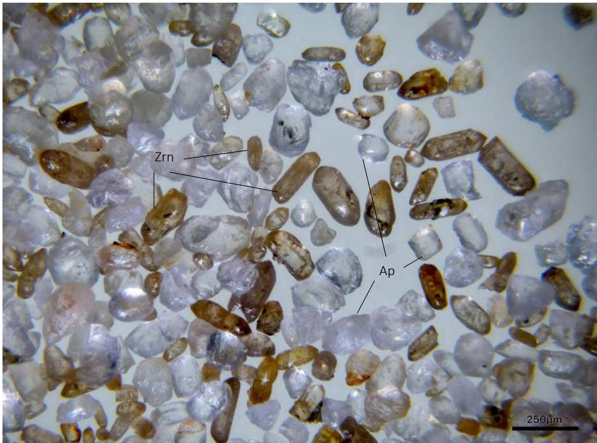
Figura 4.32: Minerales correspondientes a la fracción diamagnética separada con LST. Circón (Zrn) y apatito (Ap).
