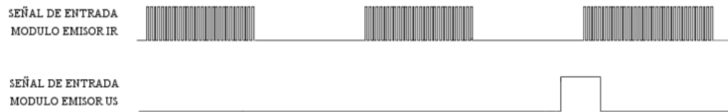
Figura 2.53: Señales de entrada al módulo emisor de infrarrojo y ultrasonido escogidas
