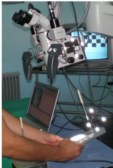
Figura 7.5: Calibración del microscopio utilizando un damero
