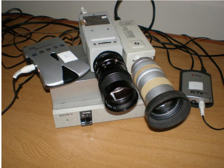
Figura 9.4: Par estéreo con cámaras analógicas distintas.
