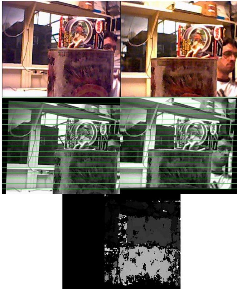
Figura 9.3: Rectificación de un par estéreo de cámaras web y mapa de disparidad.
