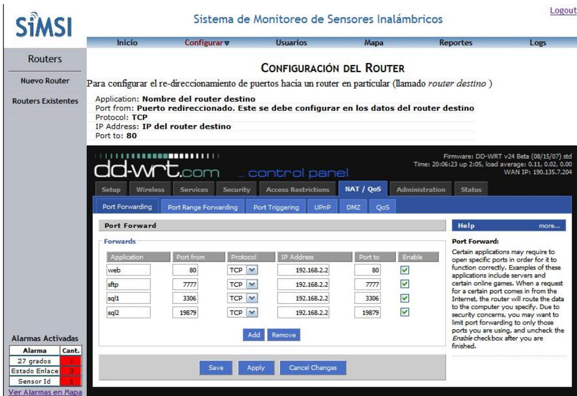
Figura D.5: Configuración del Router
