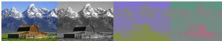
Figura 6. Descomposición de una imagen en los componentes YCbCr
