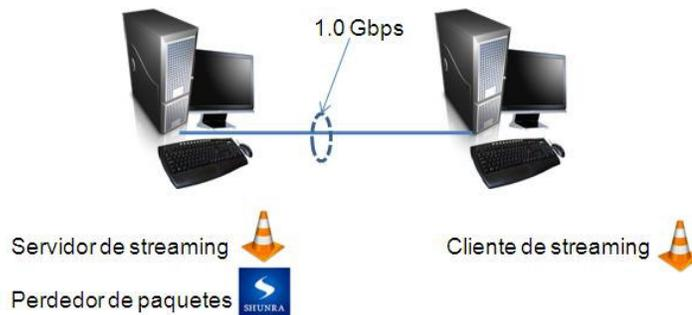
Figura 23. Arquitectura del laboratorio para la degradación de los videos
