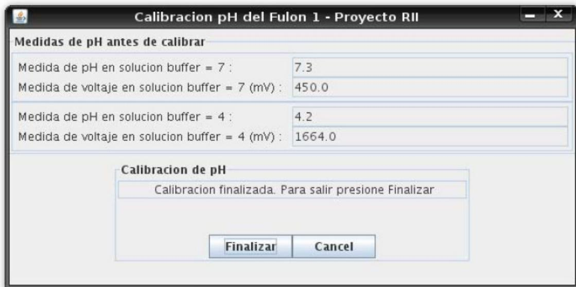
**Figura 4.7: Ventana final de la calibración**
