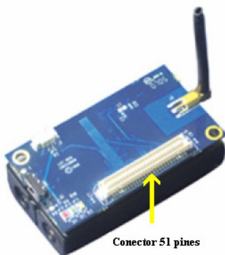
**Figura V.1: Foto del conector de expansión**
