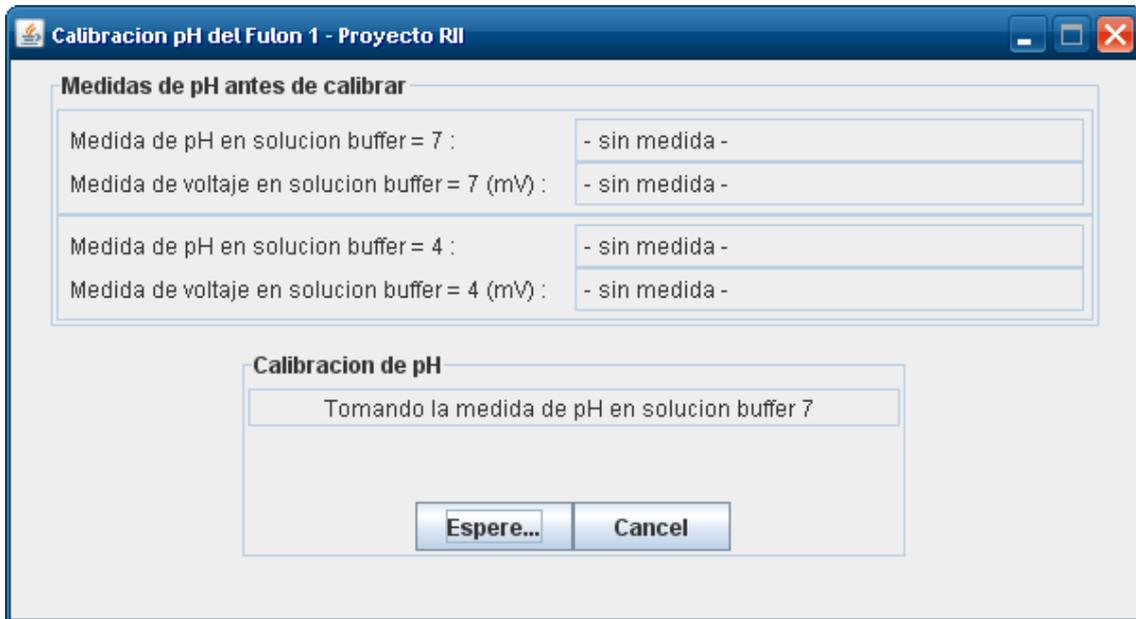
**Figura VI.4: Ventana de calibración mientras se está tomando la medida de pH 7**
