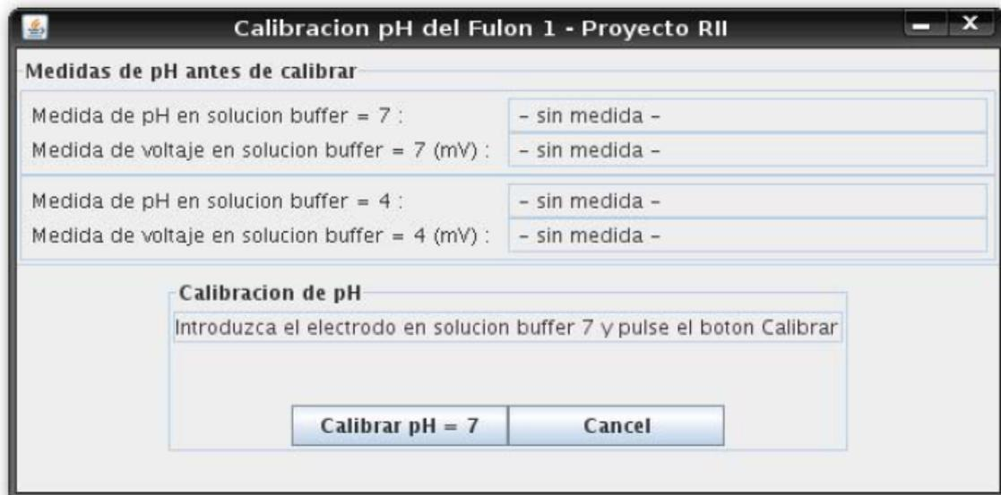
Figura 4.4: Ventana inicial de calibración del sensor de pH
