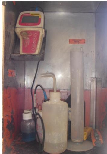
**Figura 1.3: Instrumentación actual para la medición de pH**
