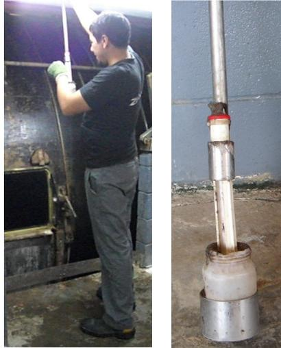
**Figura 1.2: Método actual del cliente para medir temperatura**
