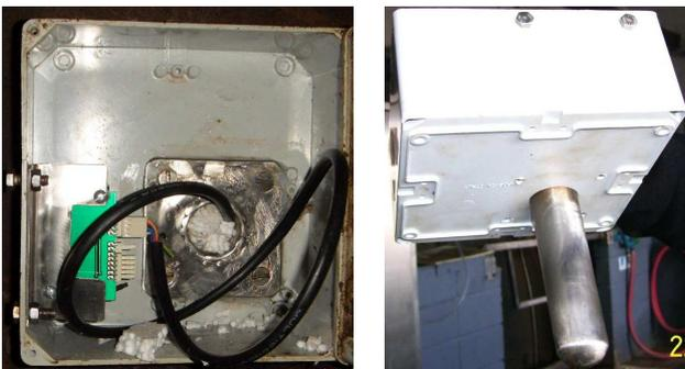
Fig. 7. Montaje del sensor de temperatura.
