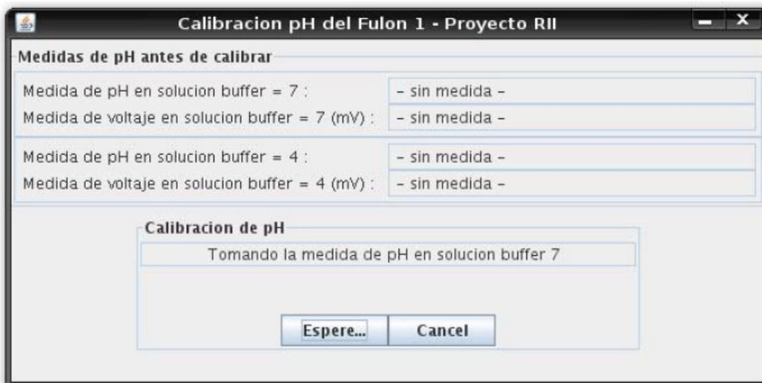
**Figura 4.6:** Ventana de calibración cuando se está tomando el pH de la solución buffer 7
