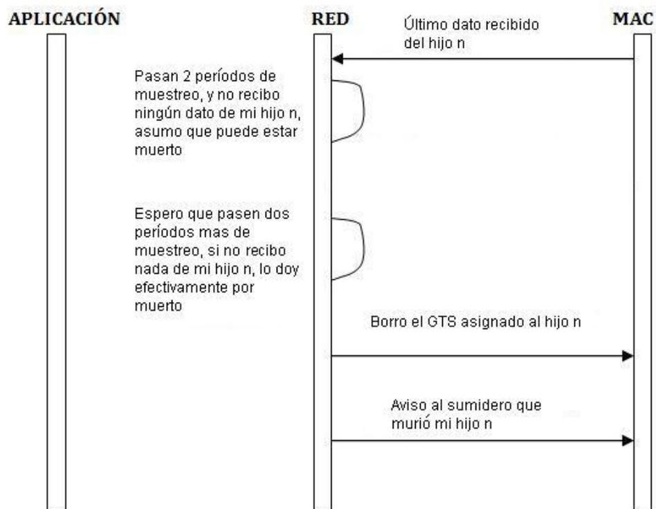
Figura 6.6: Diagrama de secuencia para el caso de uso de la Muerte de un nodo en la red para el caso de un No Sumidero.
