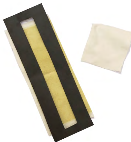
Figura 38: Muestra e implementos necesarios para desarrollar la prueba de solidez al frote.
