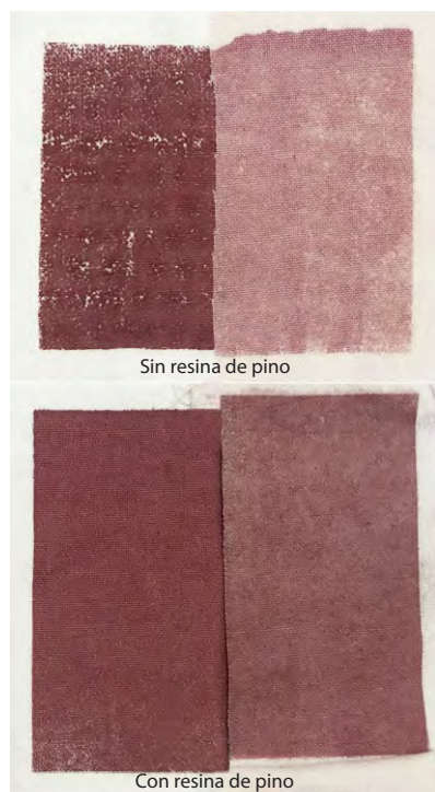
Figura 25: Comparación entre la resistencia de las tinta con y sin resina de pino.
