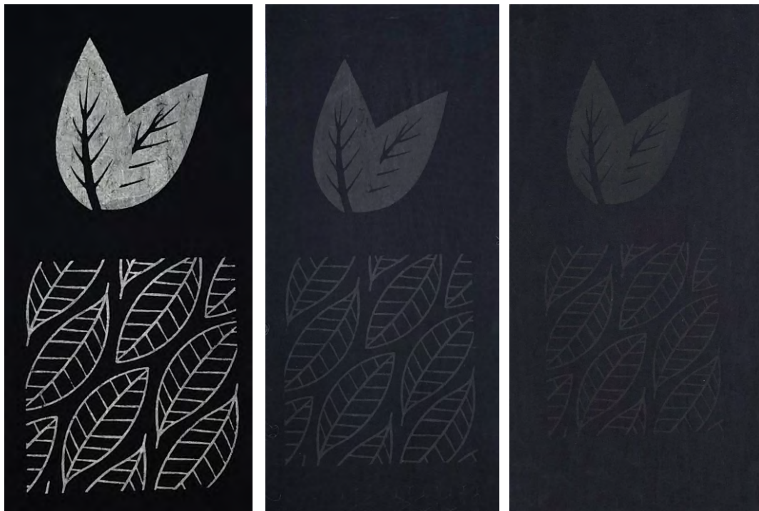
Figura 29: Rendimiento de las tintas sobre fondos oscuros. De izquierda a derecha: dióxido de titanio, arcilla colorada y yerba.
