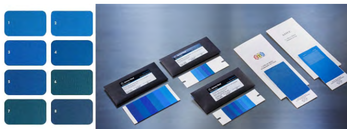
Figura 35: Escala azul utilizada para medir la decoloración en la prueba de solidez a la luz.
