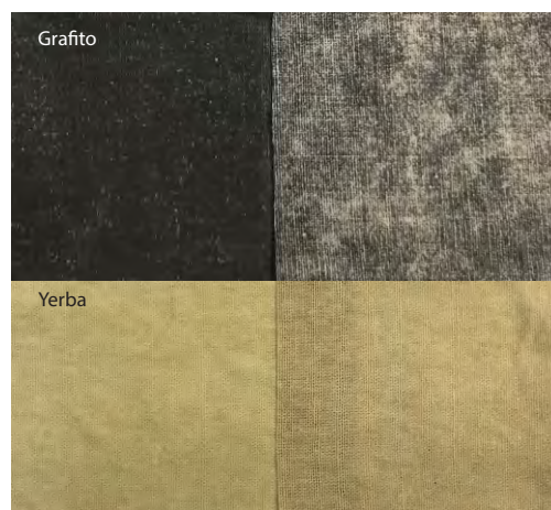
Figura 28: Rendimiento de la tinta sobre lino. Izquierda: estampado original. Derecha: después de lavar.
