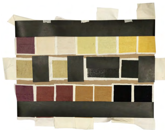
Figura 36: Muestras preparadas para ser sometidas a la prueba de solidez a la luz.
