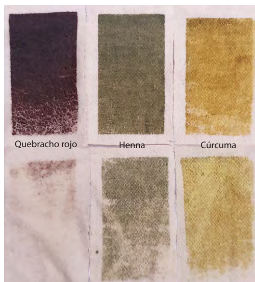
Figura 27: Rendimiento de la tinta sobre lana. Arriba: estampado original. Abajo: después de lavar
