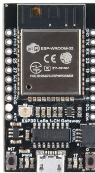
Figura 3.2: ESP32 LoRa 1-CH Gateway (obtenida de [67])
