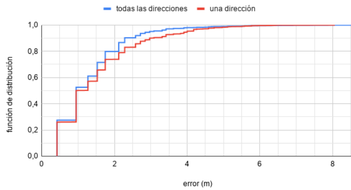
Figura 4.21: Fingerprinting para zonas 2 \times 2 - CDF del error con el cliente orientado hacia todas las direcciones y hacia una dirección
