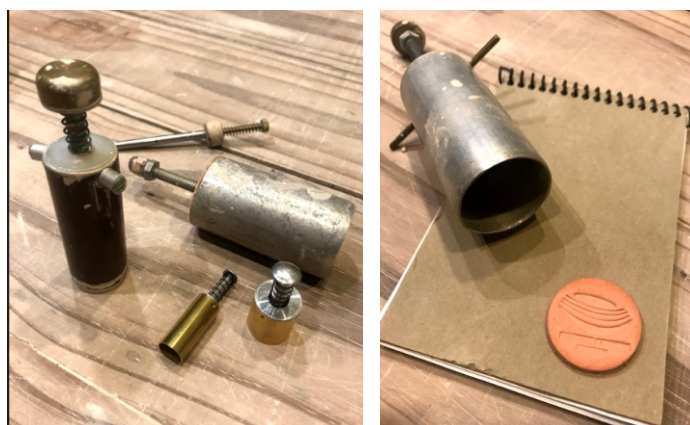
Figura 11. Sacabocados utilizadas para generar cortes circulares en las piezas. Fotografías tomadas por la autora. (2019).
