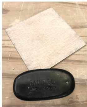
Figura 10. Herramientas utilizadas para controlar la presión ejercida en la pieza cerámica. Elaboración propia. (2019).
