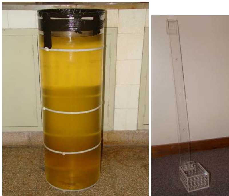
(a) Recipiente para las pruebas de la banda MICS. (b) Canasto de acrílico para ubicar el implantable.
