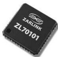
Figura 3.2: ZL70101 en encapsulado QFN de 48 pines. El thermal pad no resulta visible en esta toma.
