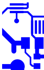
Figura 6.9: Alimentación del microcontrolador en el layout diseñado. Los pines 1 y 64 del microcontrolador corresponden a DVCC y AVCC, respectivamente, mientras que los pines 62 y 63 corresponden a AVSS y DVSS, respectivamente. Como referencia, el pin 1 es el que se ubica más a la izquierda dentro de la fila horizontal de pines.
