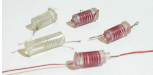
Figura 5.19: Algunas de las bobinas recubiertas con resina epoxy.
