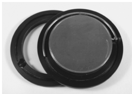
Figura 5.14: Modelo de una antena circunferencial, sobre una caja cilíndrica de latón de 50 mm de diámetro. Figura tomada de [32].
