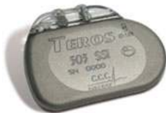
Figura 5.2: Marcapasos Teros 503, de CCC del Uruguay. Las dimensiones de este modelo son 49 \times 38 \times 7 mm. Figura extraída de [35].
