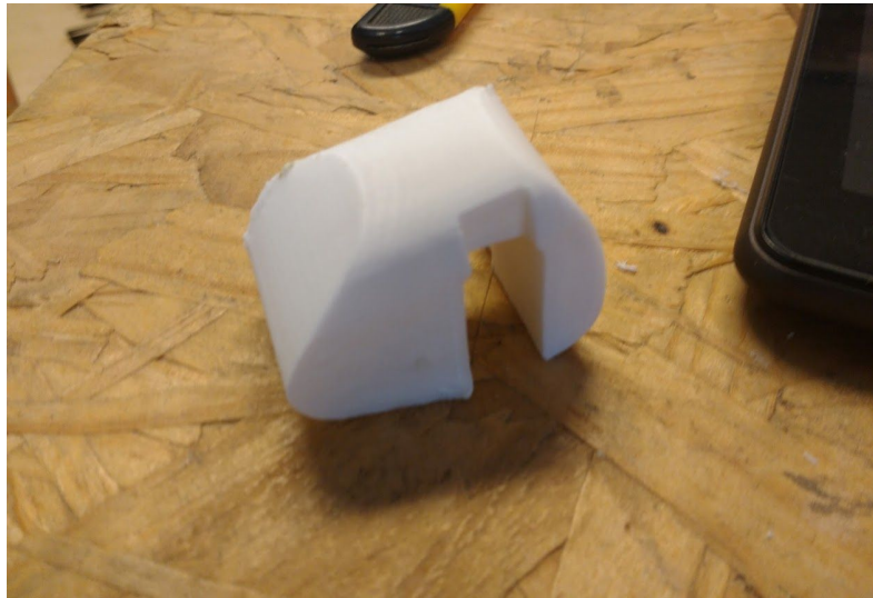
Imagen 61. Soporte de espejo con doble curvatura. Material PLA.
