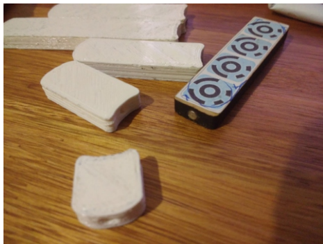
Primeros ensayos con impresión 3D. Soporte de espejo basado en secciones MDF.
