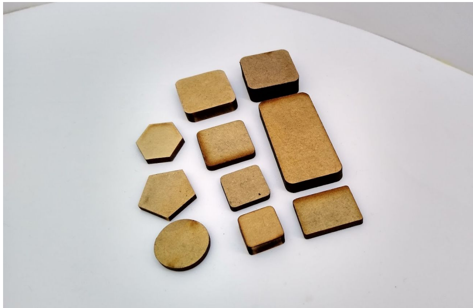
Imagen 37. Ensayo con distintas formas y espesores. Cuanto mayor es el grosor de material y el movimiento del láser aumenta el quemado de la pieza.
