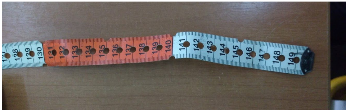
Imagen 82. Cinta métrica adaptada para ciegos. Presenta un indicador por unidad, uno lateral cada 5 unidades y doble cada 10.
