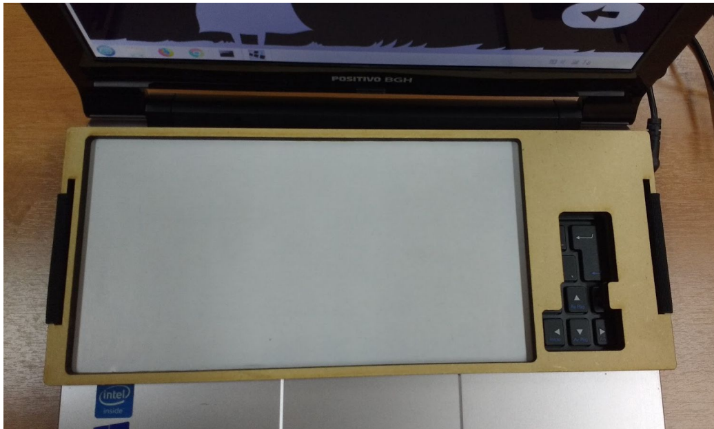
Imagen 87. Superficie de detección. Se contempla el uso de las teclas direccionales y enter.
