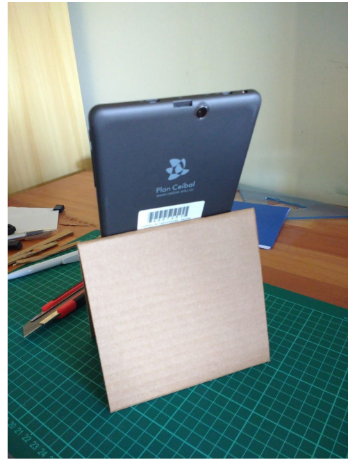
Imagen 48. Exploración de soporte plegable en cartón corrugado.
