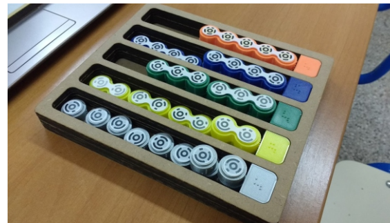
Plano de trabajo con fondo blanco para mejorar contraste y calado de acceso a teclas de control Caja para ordenar piezas con referencias por color y braille.
