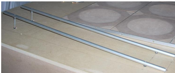
Figura 8.6: Primera versión de las canaletas con tubos de aluminio huecos.
