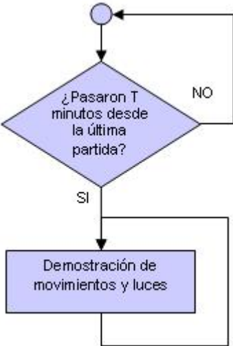
Figura 7.10: Diagrama de flujo del costate idle .
