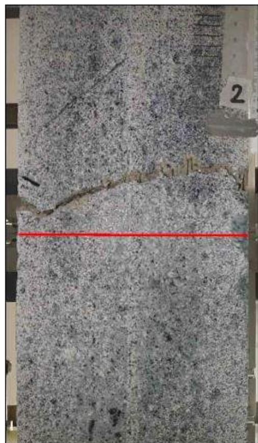
Figura 77 – Patrón de fisuración del Testigo 2.
