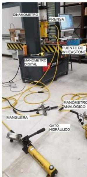
Figura 71 – Dispositivo de calibración.
