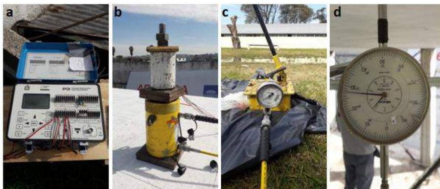
Figura 25 – Dispositivos de medida e introducción de cargas.
