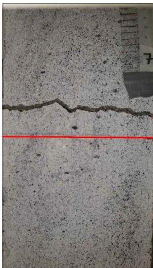
Figura 82 – Patrón de fisuración del Testigo 7.
