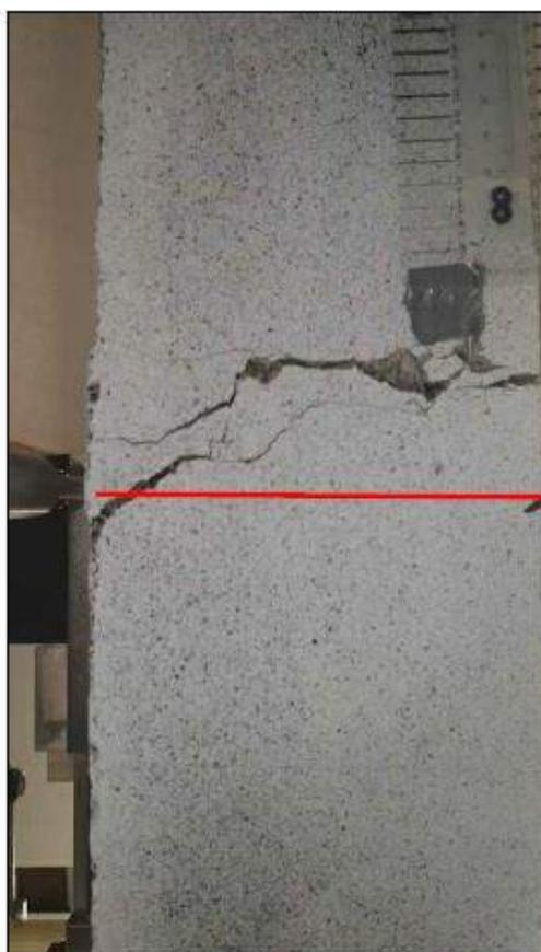
Figura 83 – Patrón de fisuración del Testigo 8.
