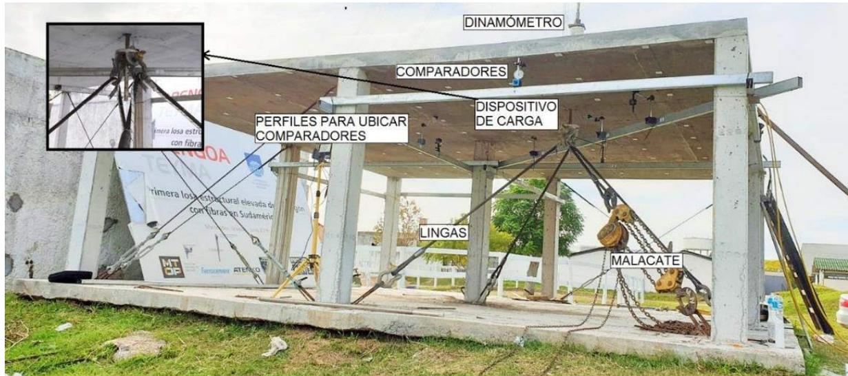
Figura 23 – Dispositivo de Ensayo.
