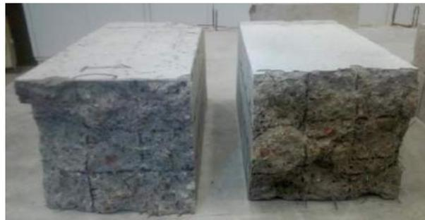
Figura 32 – Sección de rotura del testigo 10.
