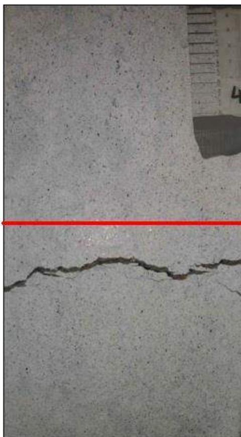
Figura 79 – Patrón de fisuración del Testigo 4.
