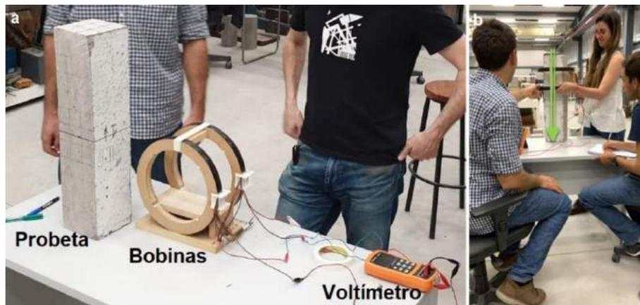
Figura 30 – Ensayo Inductivo.
