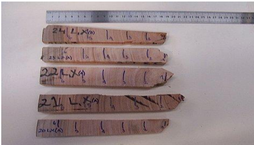
Figura No. 6: Ubicación de las probetas de largo de fibra
