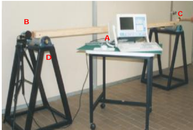
Figura No. 14: Equipo FFT Analyzer . Donde: Aa FFT Analyzer ; Ba Micrófono; Ca Martillo, Da Poliuretano
