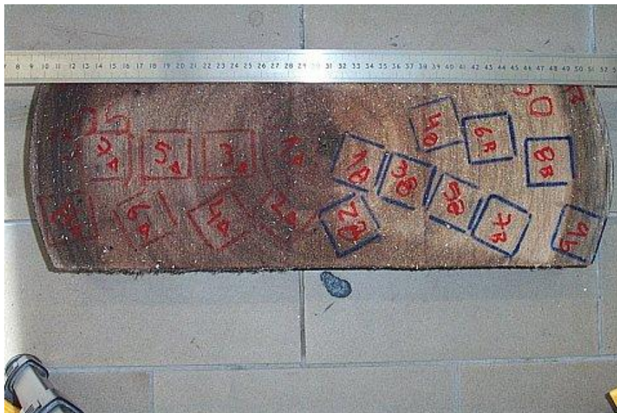
Figura No. 8: Ubicación de probetas de contracción
