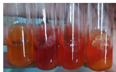
Figura 13. Tubos con DMSO pigmentado resultado del proceso de extracción. En proceso de descongelado (conservados en freezer a -20^{\circ}\text{C} ).
