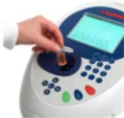
Medir la absorbancia del sobrenadante y del blanco (1 mL de agua destilada) (485 y 600 nm longitudes de onda)
