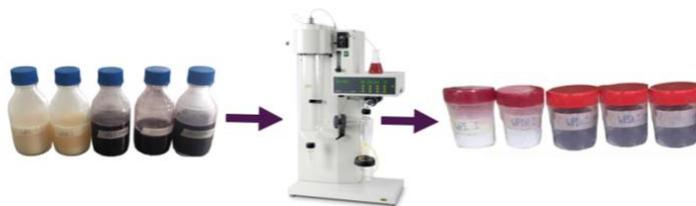
**Figura 7.** Producción de los encapsulados en polvo y sus blancos utilizando el Secador spray de mesa.
