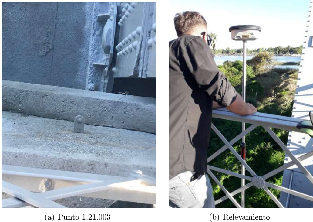
Figura 21: Relevamiento - punto de nivelación fijo IGM. Fuente: elaboración propia.
