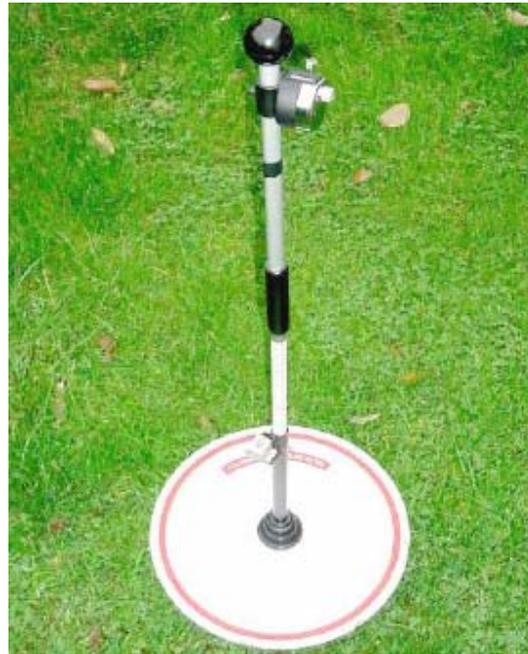
Mediante las dos fotos anteriores se pretende describir el mecanismo del plato utilizado para medir forraje. Se hace la salvedad que el plato utilizado en nuestro experimento era de sección cuadrada en lugar de redonda como el que se puede apreciar en la foto. De todas manera el mecanismo implicado es básicamente el mismo.
