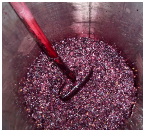
Figura 16. Operación de bazuqueos sobre el sombrero de hollejos.
