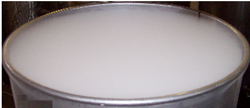
Figura 11. Tanque de MPF mostrando la sublimación del \text{CO}_{2(s)} .
