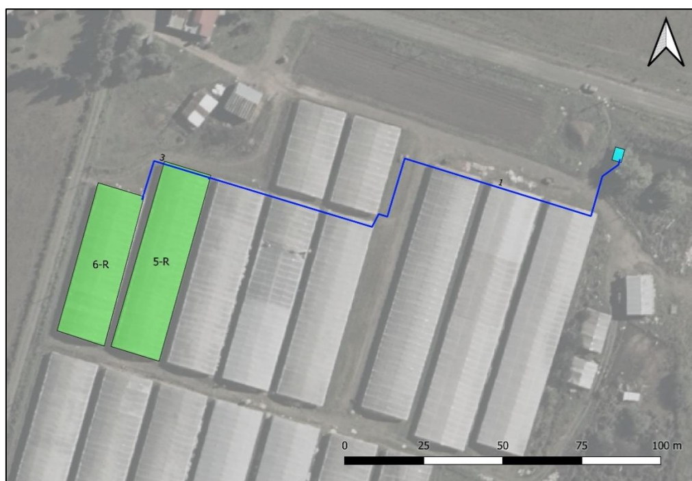
Figura 4.9: Ejemplo: Línea de tuberías que abastece los invernaderos 5-R y 6-R.
