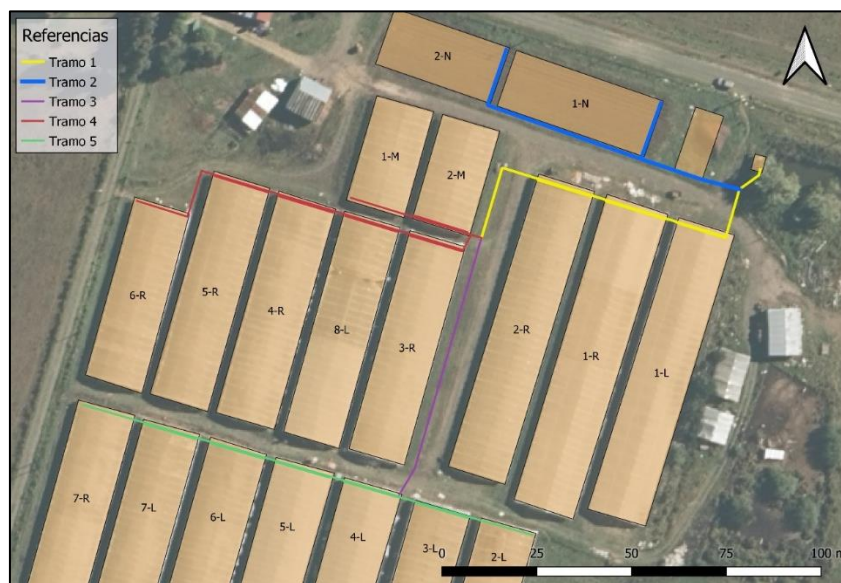
Figura 4.6: Identificación de tramos de tubería.
