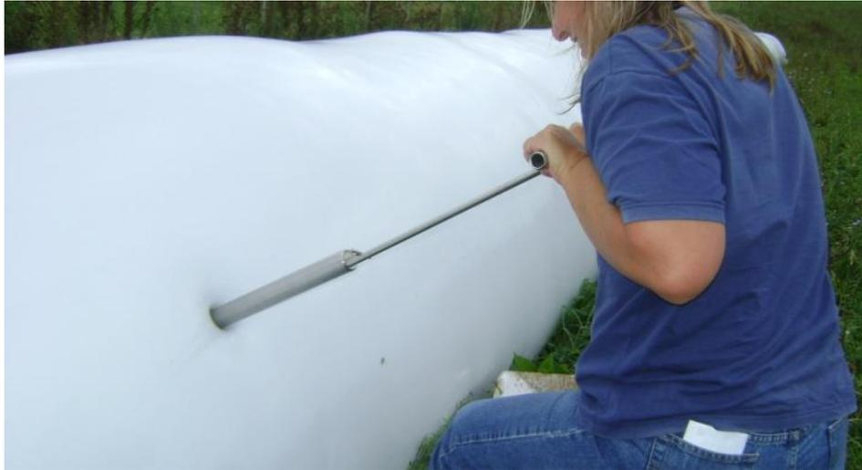
**Figura 3.** Extracción de muestras de silo-bags, realizadas mediante calador
