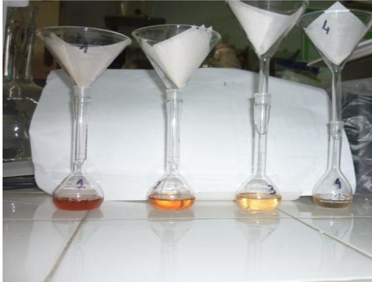
**Figura 10.** Balones con la extracción de los taninos condensados
