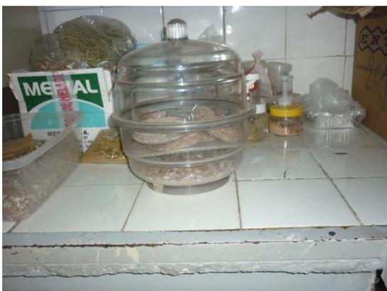
**Figura 4.** Muestras ya secas y colocadas en desecador
