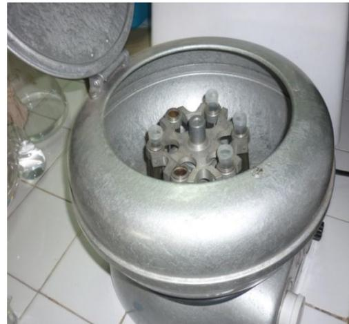
**Figura 7.** Centrífuga con las muestras
