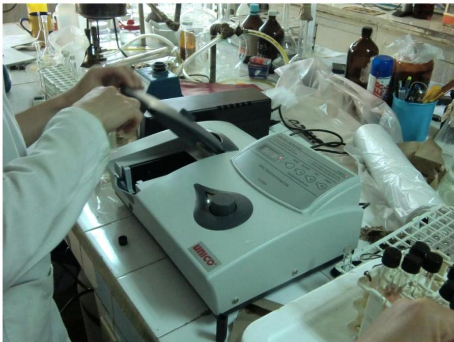
**Figura 13.** Medición de taninos en espectrofotómetro
