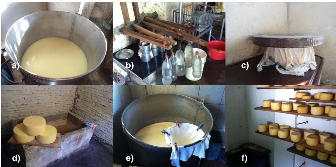
**Figura X. a) tina quesera; b) prensa de madera; c) mesada y prensa de madera; d) sala de salmuera y maduración; e) tina quesera con dispositivo de filtración casero; f) estanterías de maderas en salas de maduración.**
